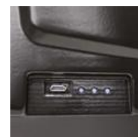
LED ukazatel nabití a micro USB vstup
